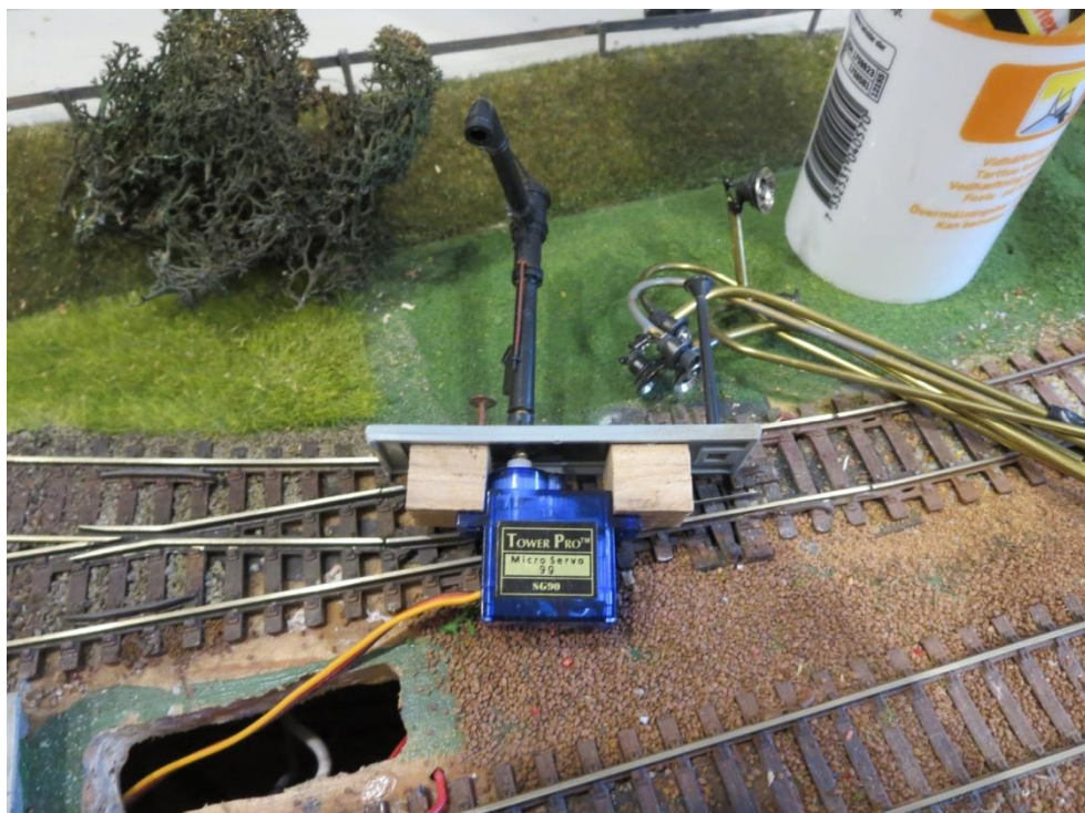
Eksempel på brug af servomotor til at dreje en vandpost ind over lokomotiv og tilbage igen. Messingrørene ved siden af er forberedelse til gadelamper med lysdioder.
